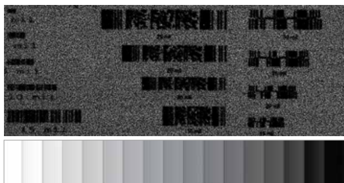
Immagine rilevata con un sensore tradizionale 8 bit
