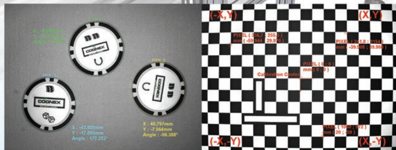
Esempio di presa con cordinarte XY e calibrazione guidata con scacchiera
